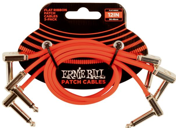
Das flache Kabeldesign und die flachen Stecker ermöglichen ein optimiertes Pedalboard-Layout und Kabelführung. Mehrere Abschirmungsmaterialien bewahren das Signal bei geringem Rauschen, und der strapazierfähige PVC-Mantel gewährleistet eine lange Lebensdauer.
