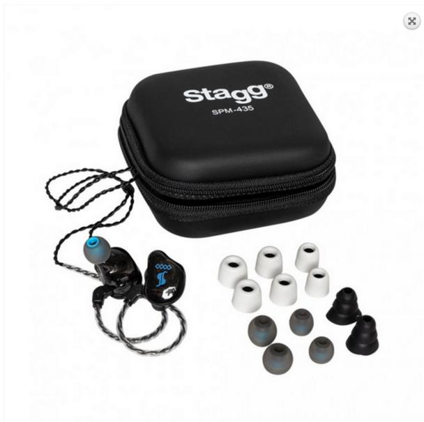
Der SPM-435 besitzt 4 Treiber, die in getrennten Frequenzgängen arbeiten, um Verzerrung zu minimieren. Das Ergebnis ist ein purer, ausgewogener Sound der das gesamte menschliche Hörspektrum abdeckt. 2 dynamische Treiber werden für Bass- und Low-Mid-Frequenzen verwendet, für eine reichhaltige Basswiedergabe. Die symmetrischen Armature Triebler liefern präzise, hohe und gleichmäßige Hi-Mid-Frequenzen.
