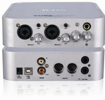
Hochwertiges USB Audio Interface mit 24-bit 96/192kHz A/D Wandlung, 4x4 i/O
